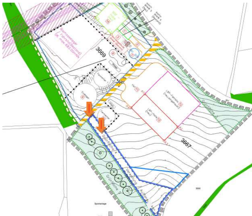
Abb. 13: Geplanter Retentionsraum mit Fleßrichtung (Pfeile) Gärsubstrat im Havariefall (Auszug Bebauungsplan-Entwurf)
