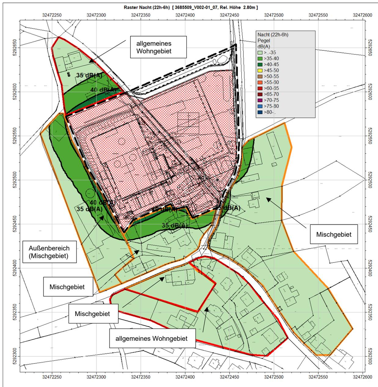
Abbildung 8: Schallimmissionsplan Nachtzeitraum, Erdgeschoß ohne Gebäude mit Einschränkungen
