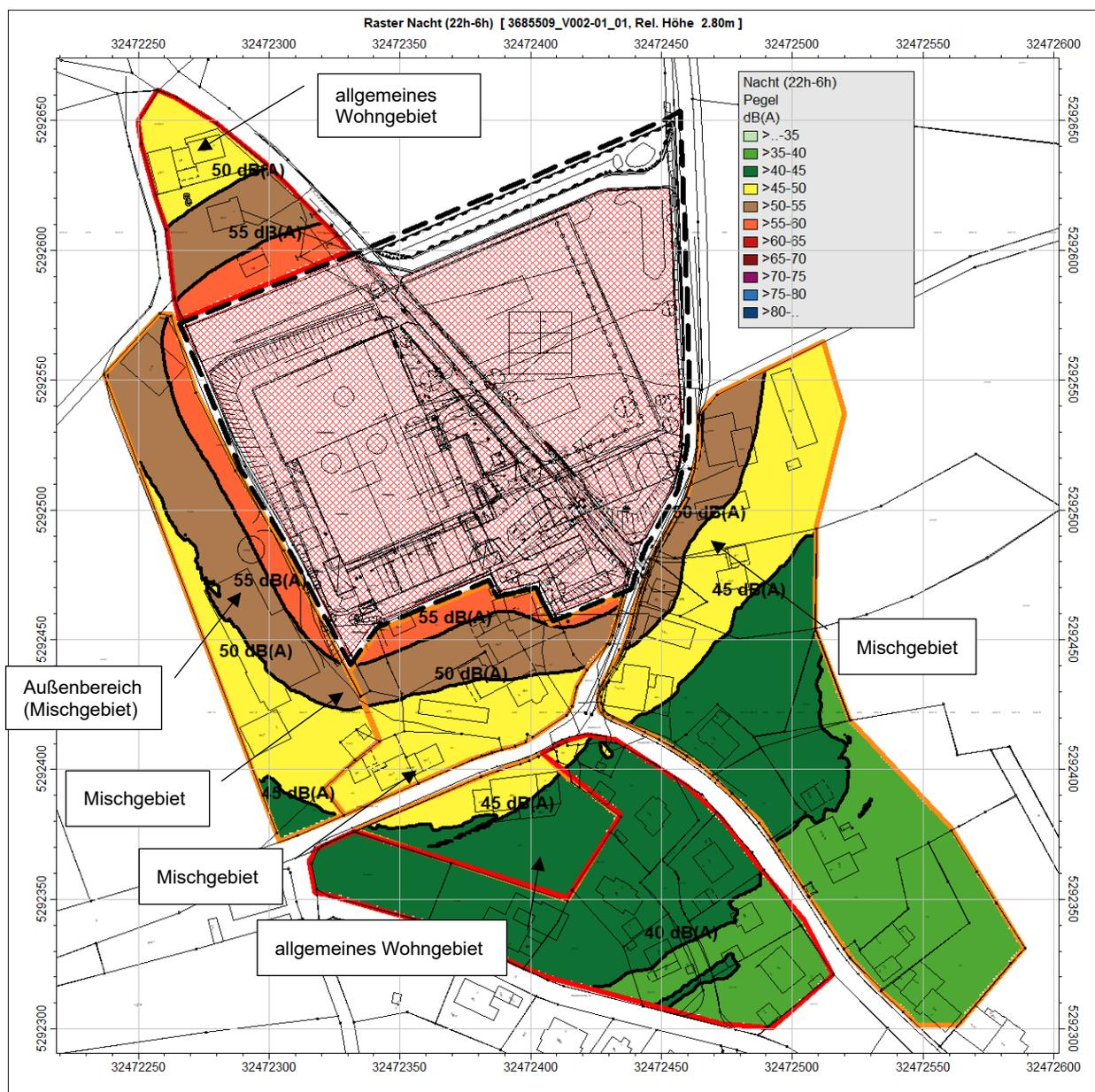
Abbildung 3: Schallimmissionsplan Nachtzeitraum, Erdgeschoß ohne Gebäude (H = 2,8 m)
