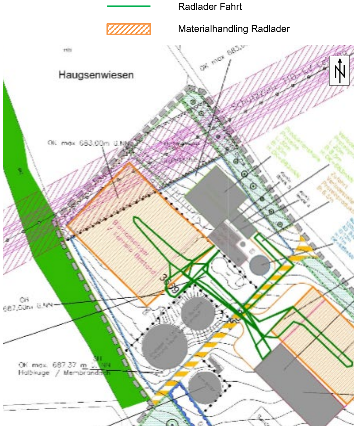
Bild 4 Lage der Geräuschquellen Radlader-Verkehr auf dem Betriebsgelände Maßstab 1:2.000
