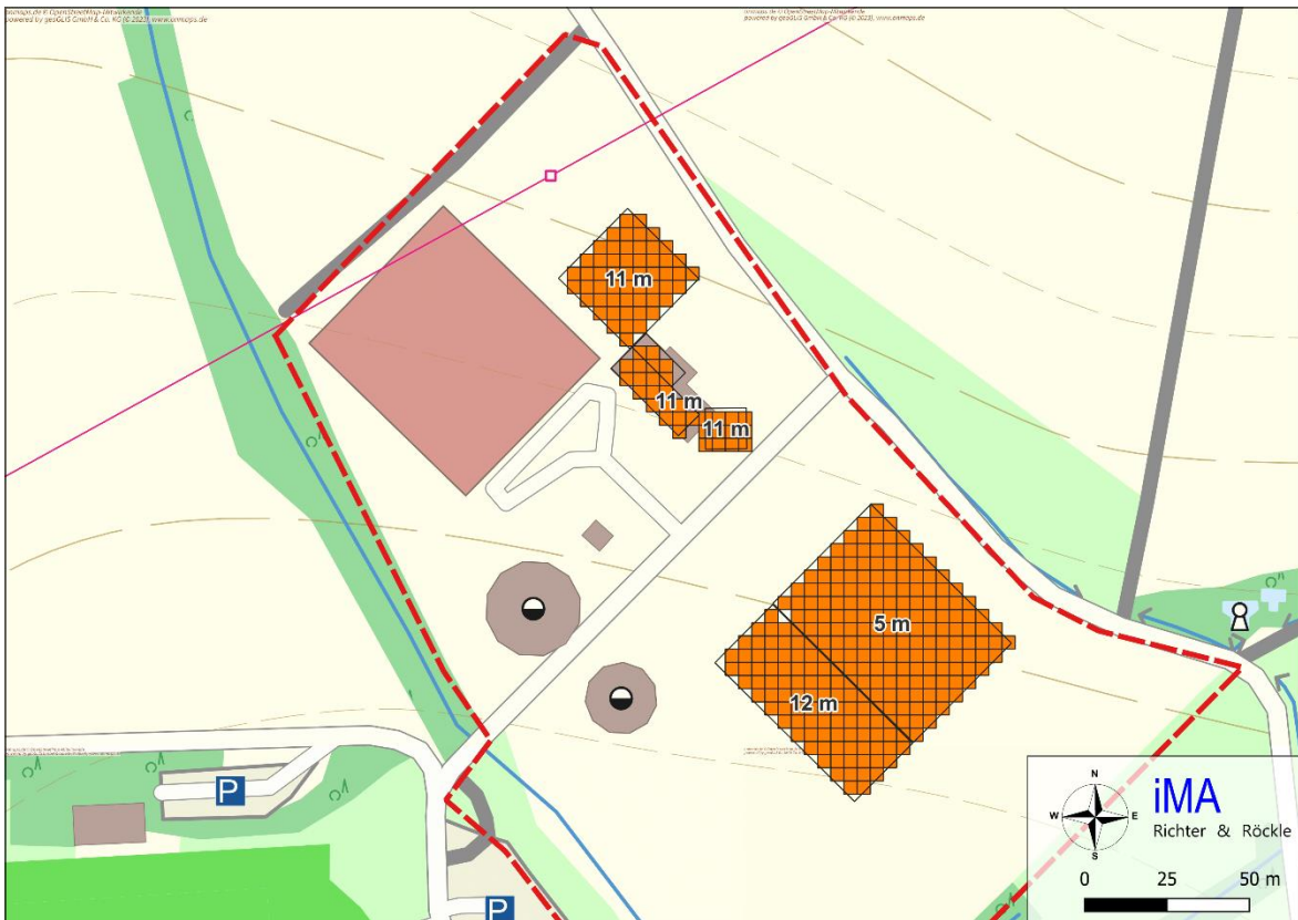
Abbildung A2-2: Lage der im Modell digitalisierten Gebäude (orange). Die Lage des Betriebsgeländes ist rot gestrichelt umrandet. Luftbildgrundlage: onmaps.de © GeoBasis-DE/BKG 2023 © Hexagon.
