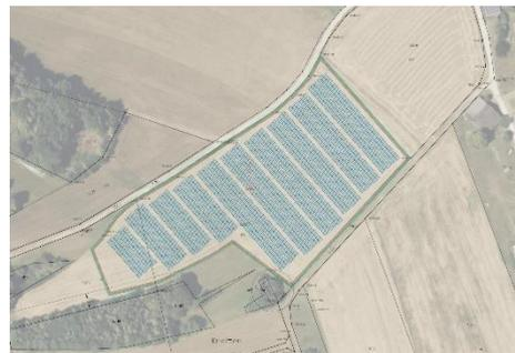
Die Module sind auf Stahlträger montiert, die durch Rammung im Boden fixiert werden. Eine Flächenversiegelung findet durch die Modulreihen nicht statt. Die Flächen unter und zwischen den Modulen erfahren eine ökologische Aufwertung gegenüber der derzeitigen Ackernutzung.
